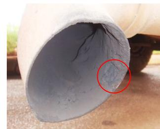
Figura 13 - Deslocamento de um bloco de fuligem da descarga.
