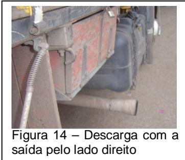
Figura 14 – Descarga com a saída pelo lado direito
