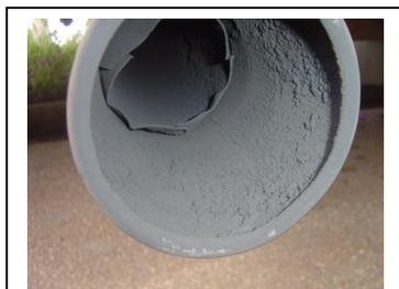
Figura 24 – Acúmulo de fuligem na saída da descarga
