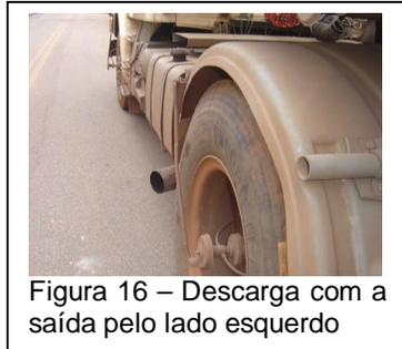
Figura 16 – Descarga com a saída pelo lado esquerdo
