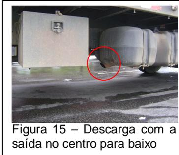
Figura 15 – Descarga com a saída no centro para baixo
