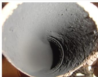
Figura 12 - Formação de placa de Fuligem na descarga.
