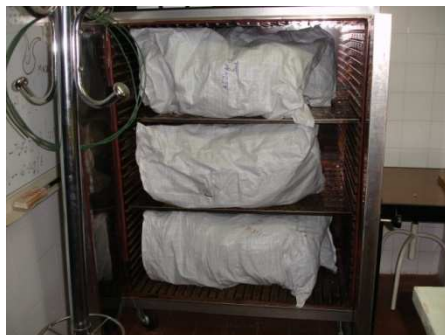
Fig 2.4.9. processo de secagem em estufa do combustível florestal
