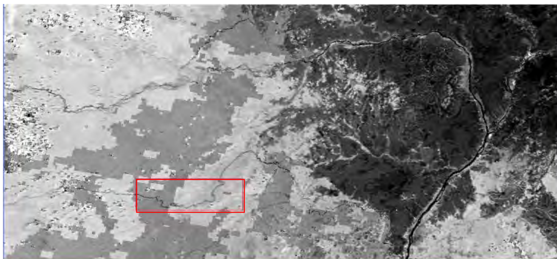
Figura 5.4 – Imagem EVI com realce de área com ruídos provocados pelo processo de formação dos mosaicos multitemporais (16 dias) do MOD-13; as áreas a Leste e a Norte, são formações savânicas, as áreas mais claras são florestas; a área de ruído poderia facilmente ser confundida com uma área afetada por incêndios florestais.
