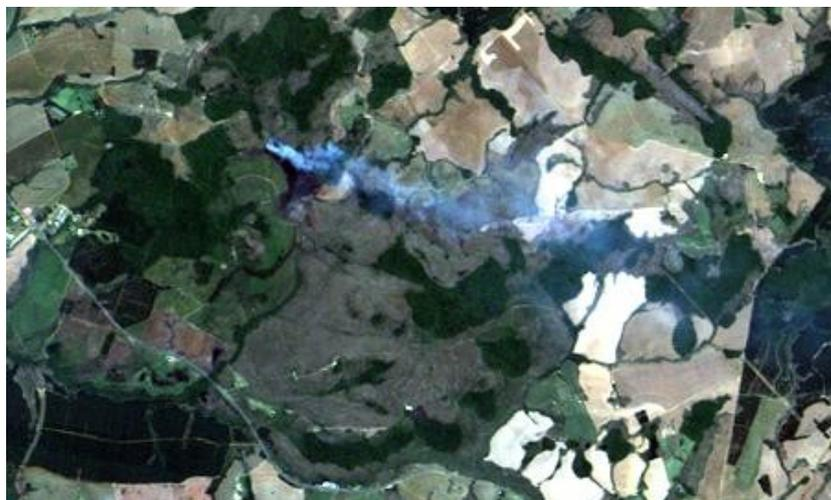
Na composição colorida R5G4B3 (Figura 9) falsa cor não se observa a fumaça, porém é uma composição adequada para estimar a área queimada que aparece em tons de roxo bem escuro e a área que está em combustão é representada em vermelho.
