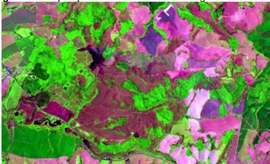
Na composição colorida falsa cor R4G3B1 (Figura 10) se visualiza a fumaça, porém em menor intensidade se comparar com a composição verdadeira cor (R3G2B1), a área queimada aparece em tons próximos ao preto, porém não é adequado estimar a área, pois a fumaça recobre parte da área queimada.
