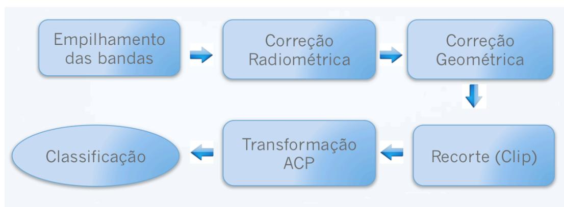
Figura 07: Fluxograma das etapas de pré-processamento.
