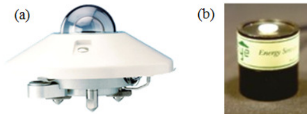
Figura 3.1.2 – A configuração das estações operadas pela Solar Radiation Network (SolRad-Net) junto das estações da rede AERONET consiste, em geral, de : (a) um piranômetro Kipp & Zonen CM-21 e (b) um sensor Skye SKE-510 com filtro de interferência com resposta entre 400 e 700 nm.
