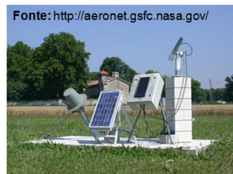
Figura 3.1. 1 – Rede mundial de fotômetros da AERONET e a configuração padrão do sistema de medição da rede.
