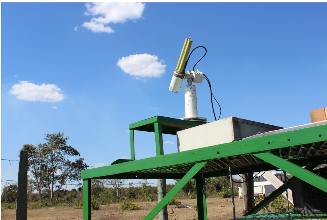
FIGURA 16 - Foto do fotômetro CIMEL da rede AERONET em operação na localidade de Cuiabá na Fazenda Miranda.
