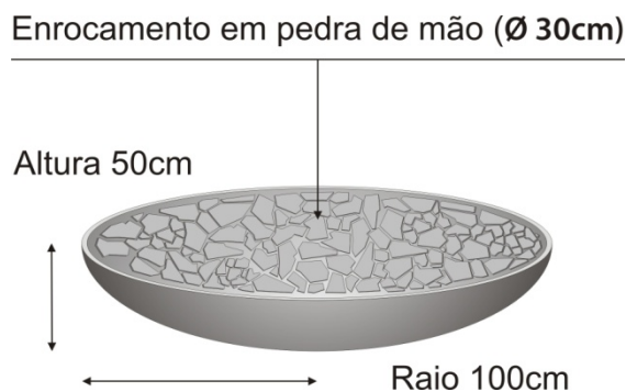
FIGURA 15.2.4.3 – Bacia de dissipação enrocadas com pedras de mão
