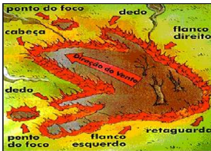
Imagem 8: Partes do Incêndio Fonte: CBMGO
