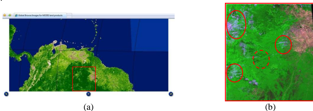
Figura 2 - 2a) Imagem sem nuvens NDVI-MOD-13; 2b) ampliação em composição RGB (B, NIR, R), com círculos mostrando nuvens e outros tipos de ruídos.
