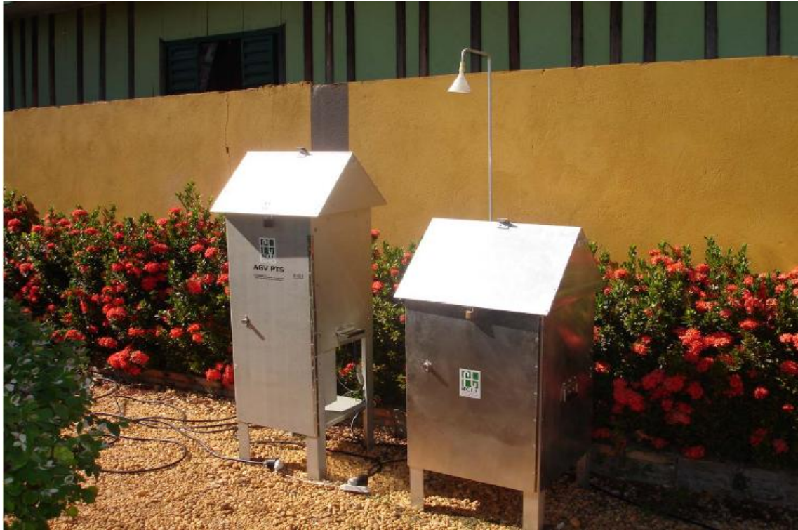
Figura 2. Amostrador de Grandes Volumes para Material Particulado em Suspensão e Amostrador de Gases da Atmosfera.
