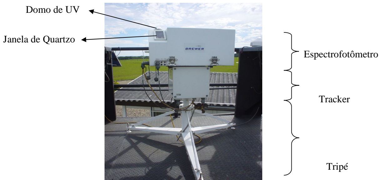
Fig. 4.3 - Espectrofotômetro Brewer MK III # 167 atualmente instalado no Observatório Espacial do Sul - OES/CRS/CIE/INPE - MCT, em São Martinho da Serra, RS.
