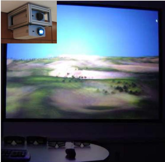
Figura 5. Projeção estereoscópica com óculos passivo.
