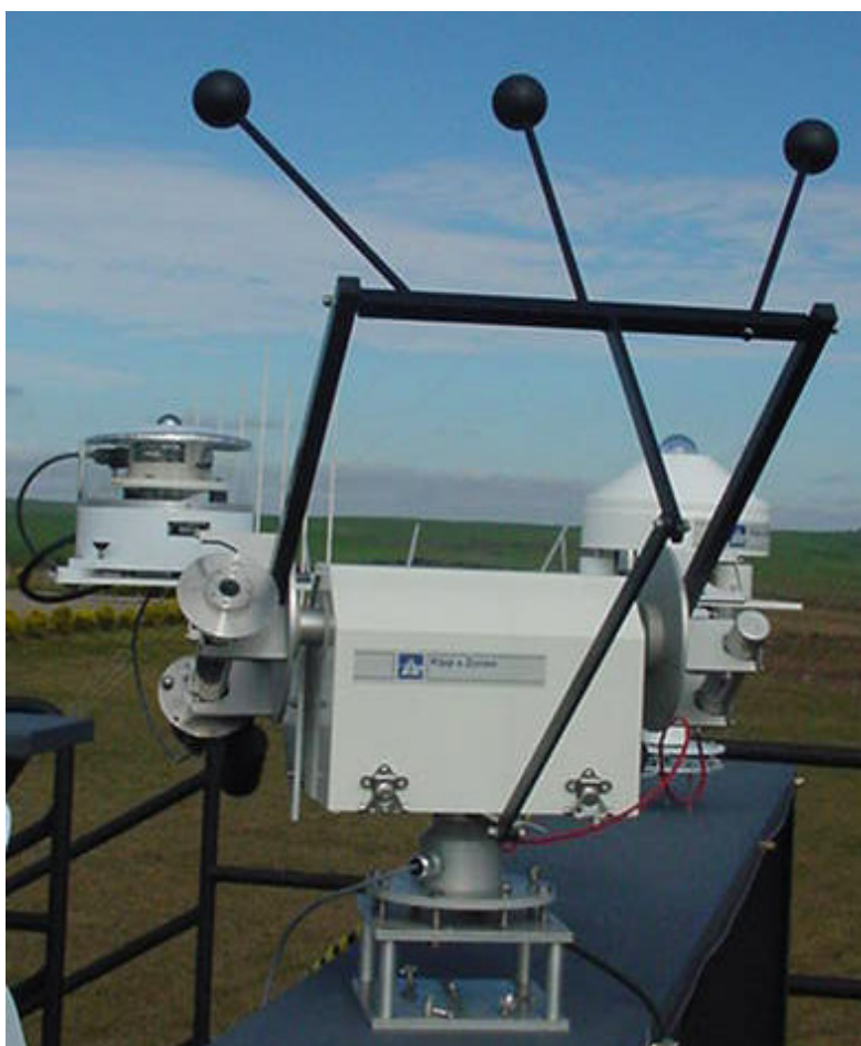
Figura 6.1 – Equipamentos instalados junto ao “tracker” Two Axis Positioner – 2AP na Estação SONDA – SMS instalada no Observatório Espacial do Sul – OES/CRS/CIE/INPE – MCT em São Martinho da Serra,RS.
