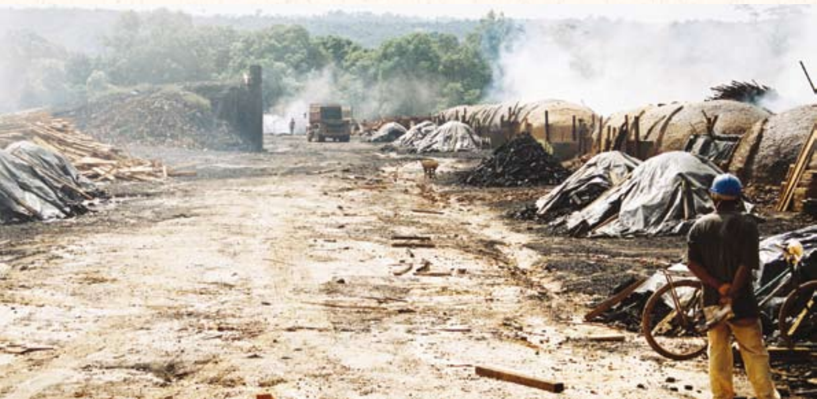
Pará - Forni per la produzione del carbone Pará - Fornos para a produção do carvão
