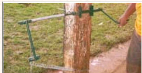
Máquina de confeccionar molas Desenvolvida por jurandir melado a partir de idéia original do produtor Rubi Jordão Krindges, de Juína - MT.
