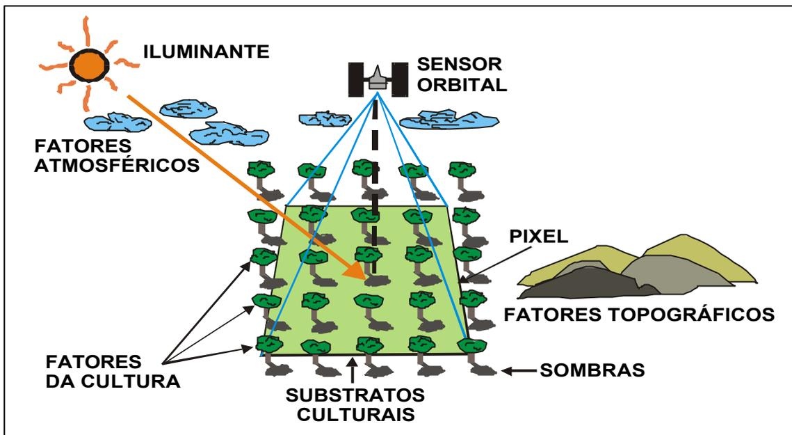
FIGURA 2.4 – Fatores que influenciam a resposta espectral dos dosséis.
