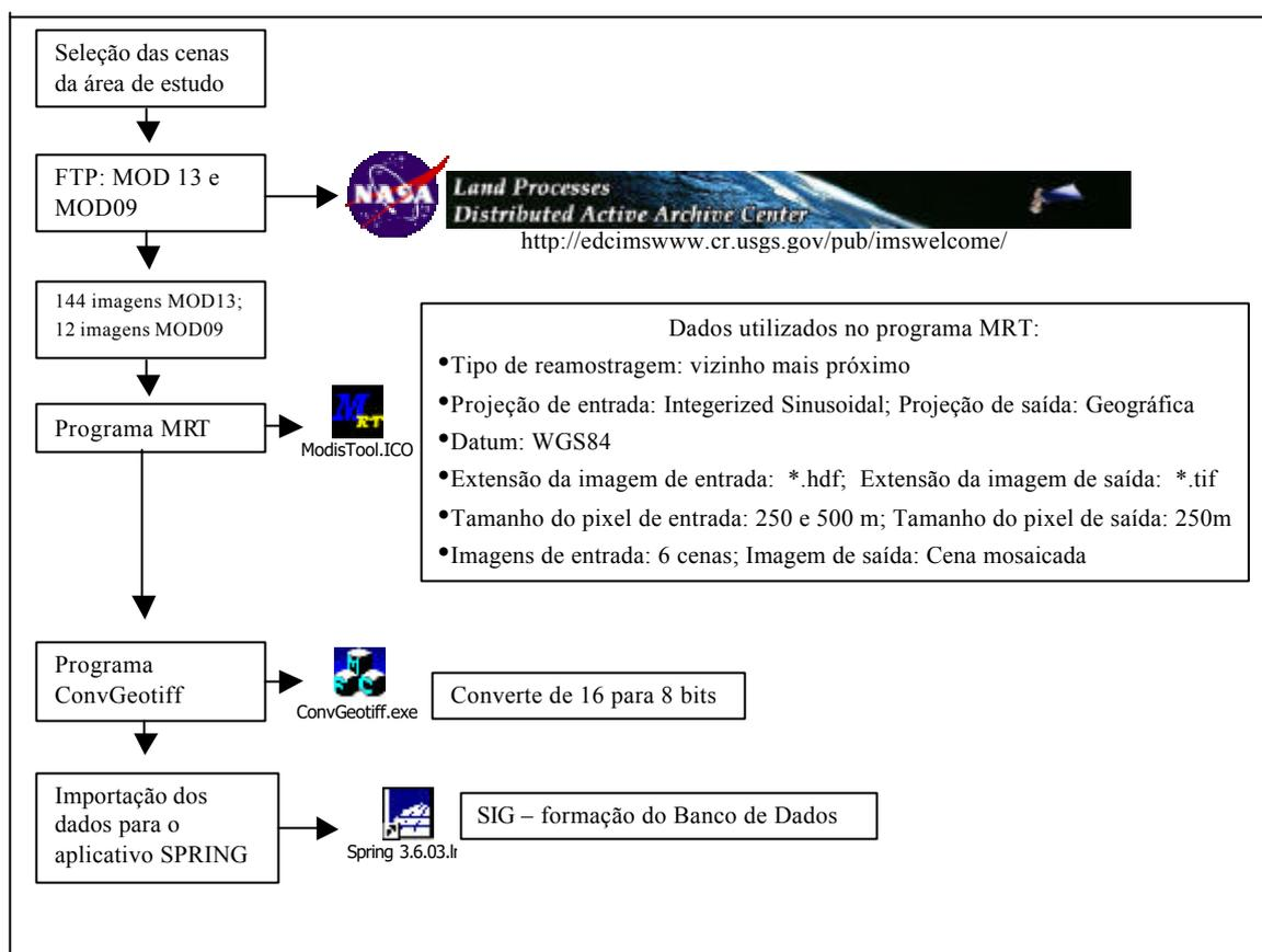
FIGURA 4.2 - Diagrama dos passos necessários para o tratamento dos dados MODIS para a importação para o Sistema SPRING.
