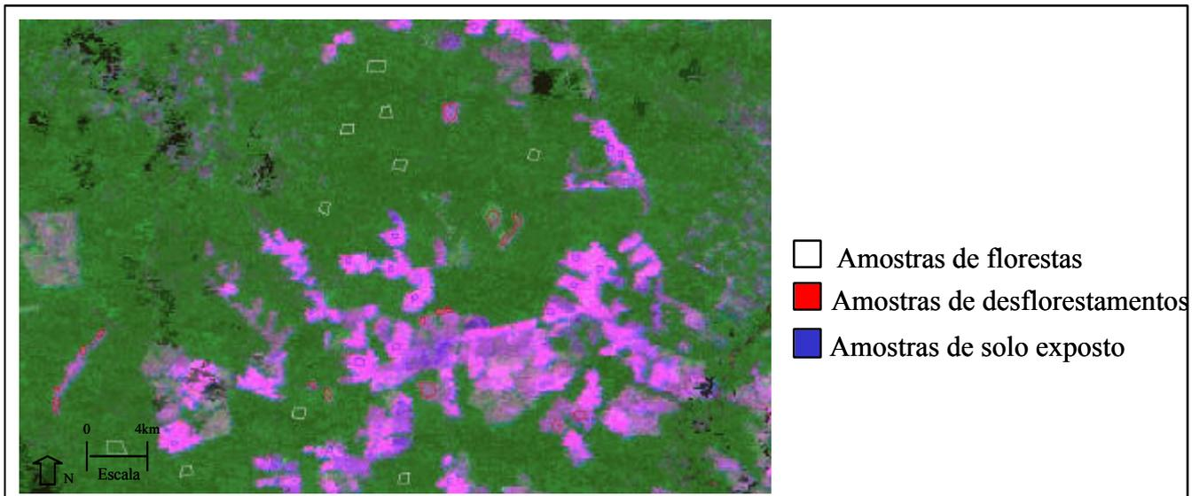
FIGURA 4.43 – Composição RGB das bandas da região do infravermelho médio, infravermelho próximo e vermelho do produto MOD13 referente ao mês de junho, e parte dos polígonos das amostras de floresta, desmatamento e solo exposto.
