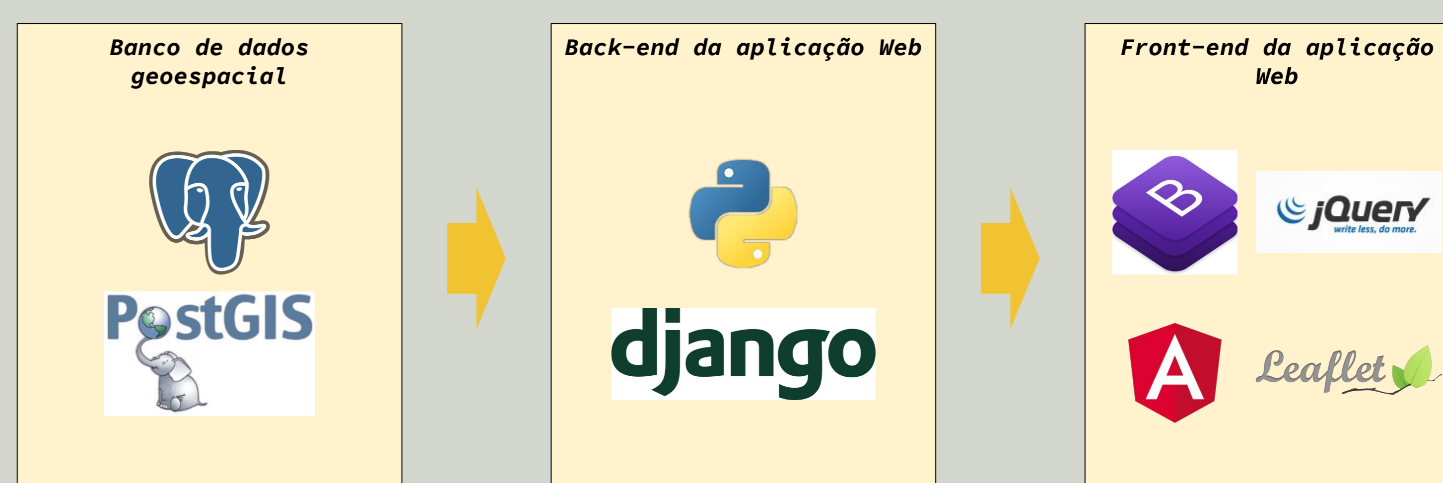
Figura 2. Diagrama da arquitetura de sistema do CIMAN Virtual, ilustrando o modelo de aplicação em 3 camadas conhecido como MVC (Model-View-Controller): as informações são persistidas no banco de dados geoespacial PostgreSQL com a extensão PostGIS (model); as regras de negócio e os algoritmos de processamento estão no back-end da aplicação Web escrita em Python com o framework Django (controller); as informações são manipuladas pelos usuários no front-end da aplicação Web desenvolvido com as bibliotecas Bootstrap, jQuery, Angular e Leaflet (view).
