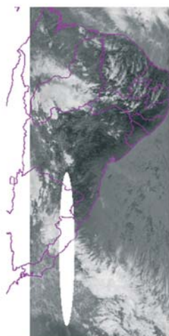
Figura 28.2 - A elipse em branco indica a parte com maior intensidade de reflexo solar, e as laterais em branco as colunas com maior distorção dos pixels ; ambas são eliminadas no processamento.
